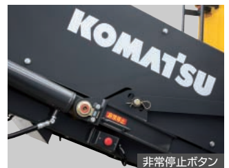
非常停止ボタン
