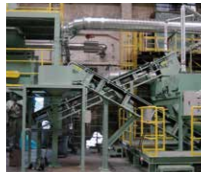
⑧ アルミ材搬送設備 (レギュラー・クライマーコンベヤ)
