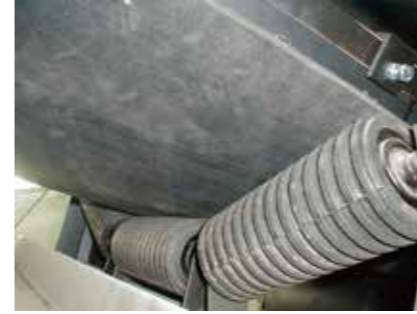
◎衝撃防止 投入部のベルトの衝撃緩和に インパクトローラ(600W以上)
