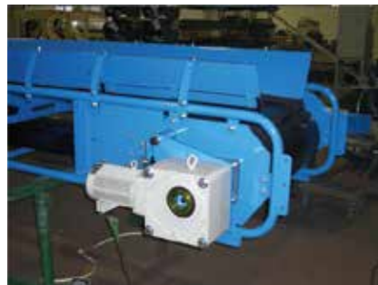
◎中空軸モータ駆動 ドライブプーリの直結取付
