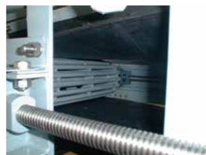
◎カゴ型テールプーリ 付着性の搬送物を運搬する時 (製作範囲確認下さい)
