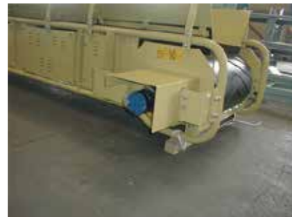
◎油圧モータ駆動 重機の油圧を利用
