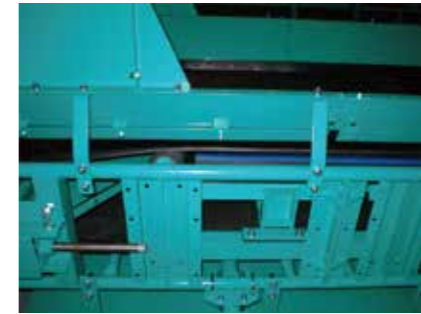
◎インパクトバーを取付
