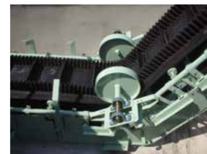
◎フレックスコンベヤ 下部変角部の片持ちプーリ
