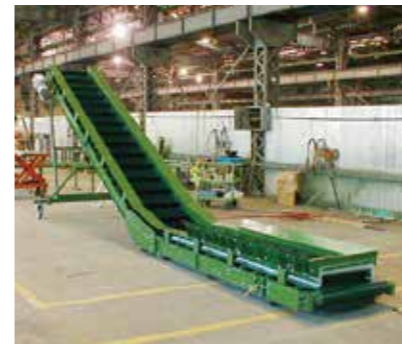
7 廃棄プラスチック搬送コンベヤ
