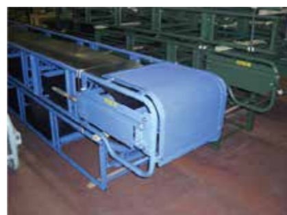
◎テール部安全カバー テールフレームの後面
