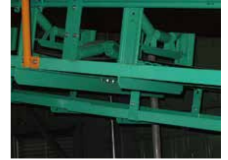
◎蛇行防止装置 リタン側ベルトの蛇行を防止する V型押さえローラ
