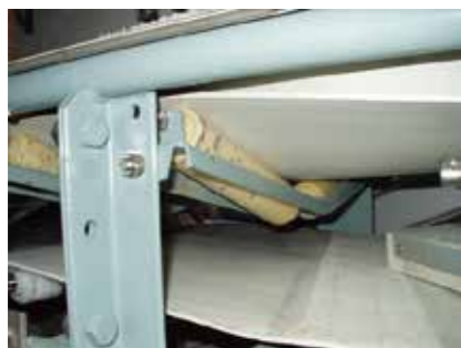
◎樹脂ローラ 水分の多い搬送物を運搬する時
