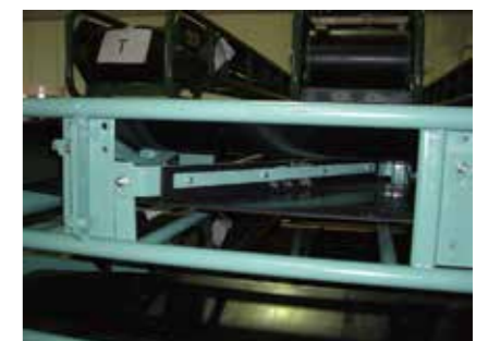
◎正逆運転 ナイフスクレーパを取付 リタン側に取付
