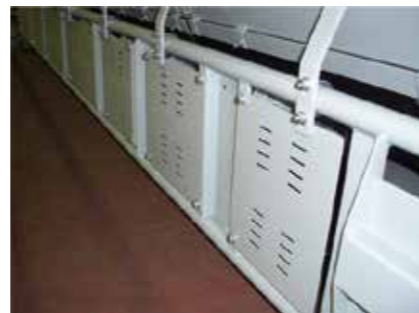
◎サイドカバー コンベヤフレームの安全カバー
