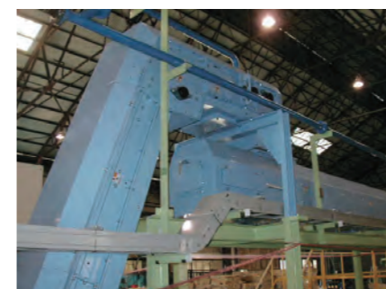
舟底型 石灰搬送コンベヤ
