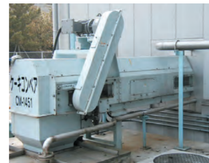
舟底型 脱水ケーキ搬送コンベヤ
