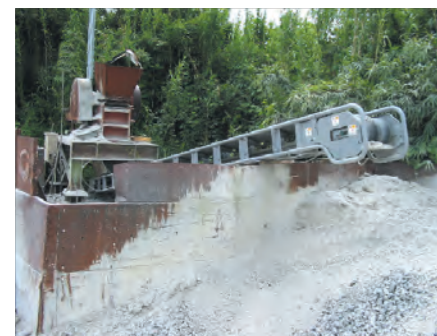
舟底型 砂利・砂搬送コンベヤ
