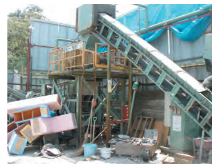
舟底型 建設廃材搬送コンベヤ
