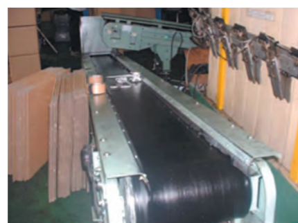
平型 プレス製品搬送コンベヤ
