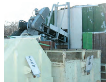
舟底型 空缶選別コンベヤ (マグネットブーリー式)
