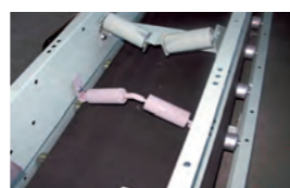
M型逆押しローラー
