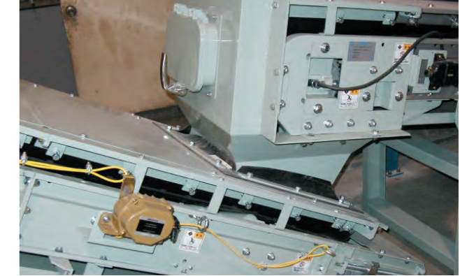
可燃ゴミ搬送コンベヤ 舟底型
