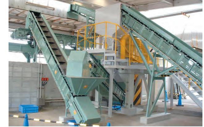
ガラスカレット処理プラント 舟底型 クライマ型
